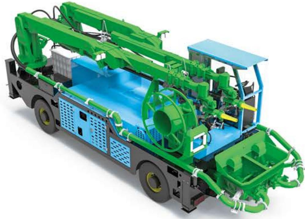
GHP6015G-II 双臂混凝土湿喷台车针对大断面和超大断面隧道支护过程中单臂混凝土湿喷台车喷射效率不高、喷射能力不足以及突发情况拖延整个施工进度等问题，研制开发的一种新型、高效混凝土湿喷机。
